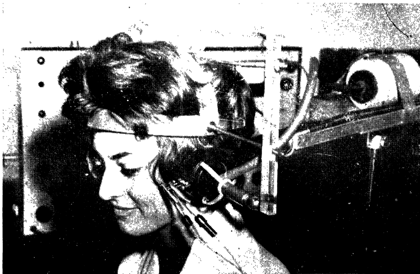
Рис. 3. Измерение акустического импеданса человеческого уха.
