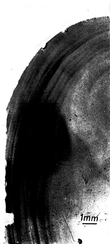
Obr. 6: Topogram (TRV) příčného řezu krystalem Si.
