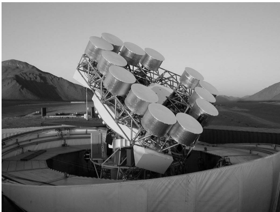
Obr. 3. CBI (Cosmic Background Imager) — zařízení složené ze 13 částí a určené pro interferometrii ve frekvenční oblasti 26 až 36 GHz. Používá se pro studium mikrovlnného reliktního pozadí s vynikajícím úhlovým rozlišením. Nachází se v severním Chile v nadmořské výšce 5080 m.
