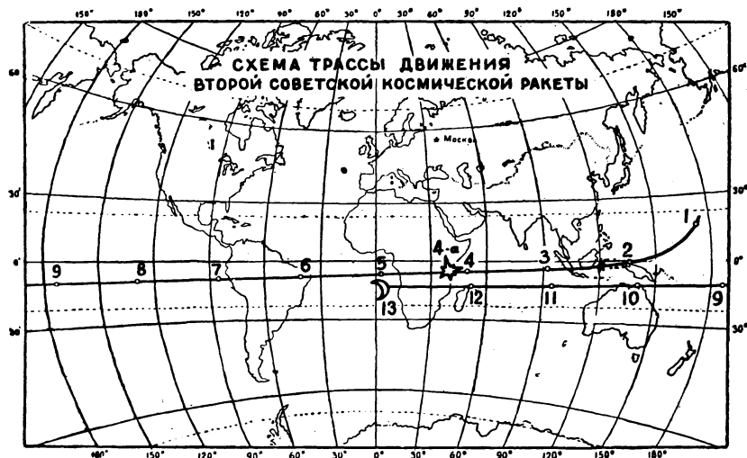
Obr. 1. Schéma trajektorie druhé sovětské kosmické rakety. Čísla 1 až 13 označují projekce jednotlivých póloh rakety za jejího letu: 1 – ve dvanáct hodin 12. září 1959; 2 – v patnáct hodin, 78 500 km od Země; 3 – v osmnáct hodin, 112 000 km od Země; 4 – v jedenadvacet hodin, 142 000 km od Země; 4a – vytvoření umělé komety (sodíkového mraku); 5 – nula hodin 13. září 1959, 171 000 km od Země; 6 – ve tři hodiny, 198 000 km od Země; 7 – v šest hodin, 224 000 km od Země; 8 – v devět hodin, 250 000 km od Země; 9 – ve dvanáct hodin 13. září 1959, 274 000 km od Země; 10 – v patnáct hodin, 298 000 km od Země; 11 – v osmnáct hodin, 322 000 km od Země; 12 – v dvacetjedna hodin, 346 000 km od Země; 13 – nula hodin, 02 minut, 24 vteřin dne 14. září 1959, 371 000 km od Země, dopad rakety na měsíční povrch.
