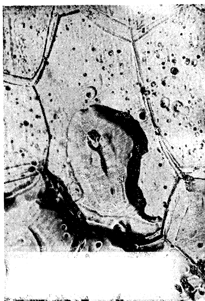
Obr. 9. Vzorek byl ve vakuu při vysoké teplotě namáhán tak velikou silou, že se po několika vteřinách přetrhl. Na obraze je zachycen posuv zrn a část zrn v těsné blízkosti přetržení.
