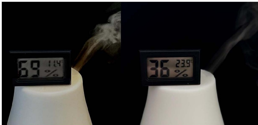
Obr. 2: Odpařování vody při vysoké vlhkosti a nízké teplotě (vlevo) a při nízké vlhkosti a vyšší teplotě (vpravo)
